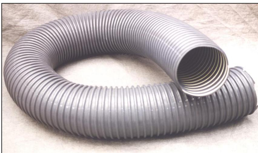
Tubo flessibile in PVC plastificato con spirale di rinforzo in PVC rigido antiurto. Idoneo per aspirazione di ARIA e FUMI. Buona resistenza in aspirazione. Temperatura d'impiego: -15° +60° C.
